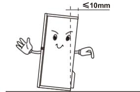
· Вы можете отрегулировать ножки вручную или с помощью подходящего гаечного ключа.
